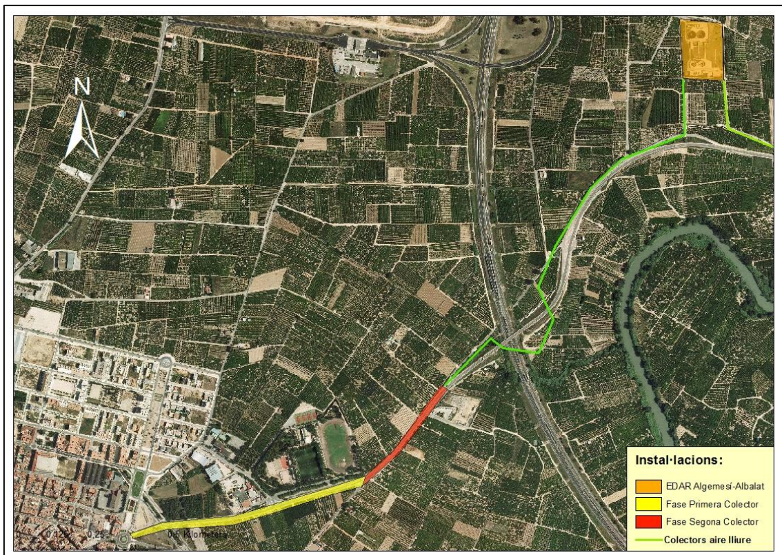
Figura 12: Construcció del nou col·lector d'aigües pluvials i la línia a l'aire lliure que connecta amb l'EDAR Algemesí-Albalat de la Ribera. Ortofoto del 2012.
